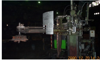
Ein Teil der Sensoren und Steuerventile am Roboterarm sind über dezentrale Beckhoff-Module per Profibus-DP mit
