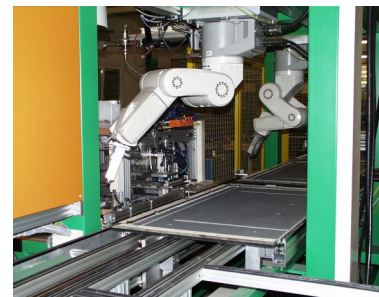
neuen Transport der teilmontierten Ventile kam ein Knickarmroboter mit 5 Achsen und
